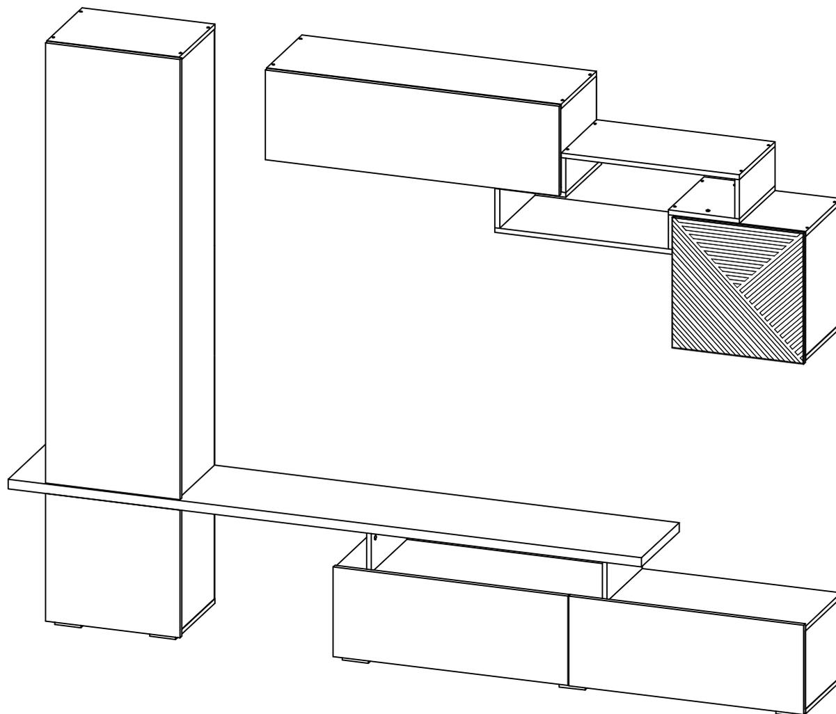
УНИВЕРСАЛЬНАЯ СБОРКА, Нагрузка на тумбу - не более 30кг при равномерно распределенной статической нагрузке! Нагрузка на навесные модули - не более 20кг при равномерно распределенных статических нагрузках!
