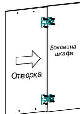
Крепят петли шурупами 3,5х15мм к фасаду. Затем в стоячем положении шкафа вплотную приложит торец фасада с прикрученными петлями к торцу боковины шкафа, и крепят ответные планки петель к боковине шурупами 3,5х15мм. После чего отрегулировать все фасады.
