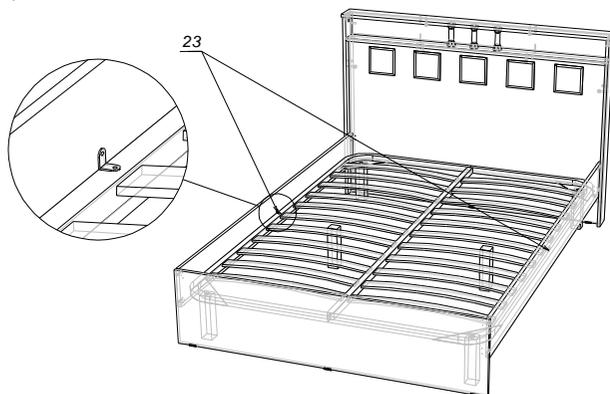
Схема установки монтажных уголков:
