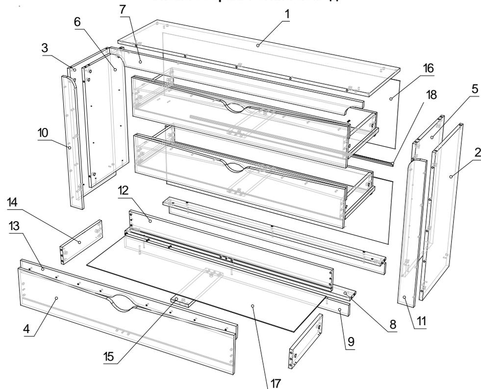
Внимание! В связи с использованием при комплектации мебели шариковых направляющих различных производителей возможны несоответствия установочных характеристик данных комплектующих. В случае выявления данного факта, просим самостоятельно произвести разметку под крепление направляющих соосно с имеющимися базовыми наметками для крепления любым подручным инструментом, соблюдая все технологические отступы.
